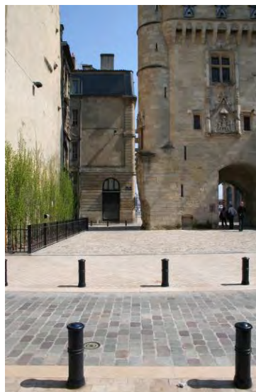
Bordeaux, aménagement sobre valorisant le patrimoine bâti. Utilisation de la pierre et hiérarchisation des circulations : pierre calcaire pour les circulations douces/granit pour les bandes de roulement. Traitement différencié pour les circulations douces et les abords du monument.
