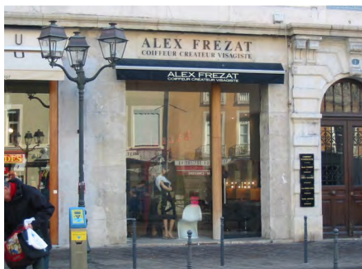
Enseigne positionnée au dessus de l'ouverture sans dépasser la largeur. Grenoble.
